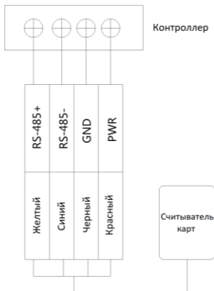
Рисунок 3-3 Подключение для режима связи RS-485
