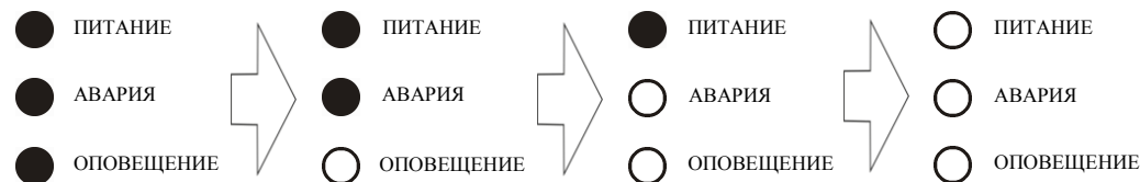
Рис. 9. Индикация режима «ПРОГРАМИРОВАНИЕ» (● – горит, ○ – не горит)
